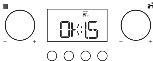
Rys.25 Wyświetlić wartość ciśnienia w instalacji w trybie czuwania
